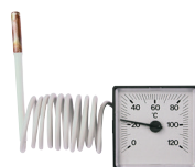
Type ATH - genau anzeigendes Kapillarrohrthermometer, Anzeige von 0 - 120°C
